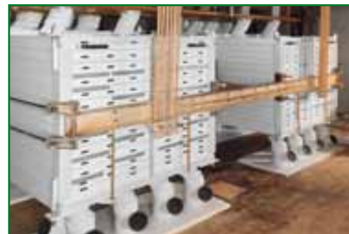
Plansichter con telai a spazzola rotante trasformato con nuovi telai a passaggi divisi con telaini staccianti in alluminio estraibili dall'interno.
