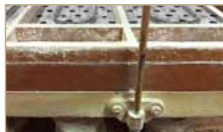
Plansichter con telai a spazzola rotante trasformato con nuovi telai a passaggi divisi con telaini staccianti in alluminio estraibili dall'interno.
