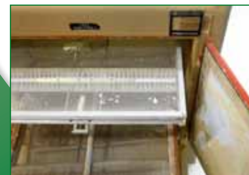
Telai in alluminio per ogni modello di semolatrice Frames in aluminum for each model of purifier
